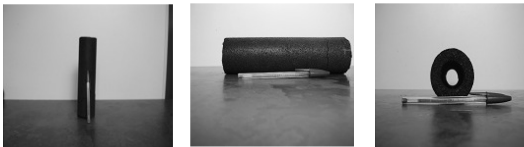
Figura 1 - Coluna de carvão ativado impregnado com prata 0,8% (CARBONFLOCK®).
