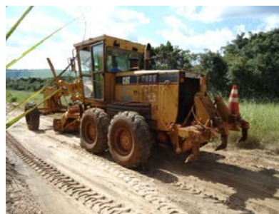
Figura 2 – Motoniveladora em operação na área de estudo e de um carreador após a sua passagem.
