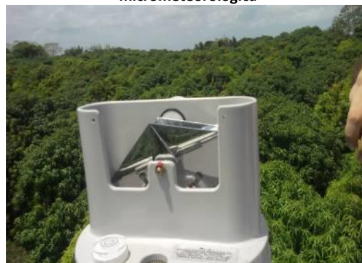
Figura 2: Pluviômetro automático basculante da torre micrometeorológica
