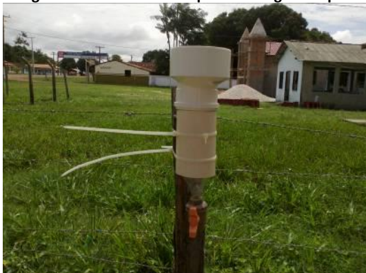
Figura 1: Pluviômetro adaptado com garrafa pet
