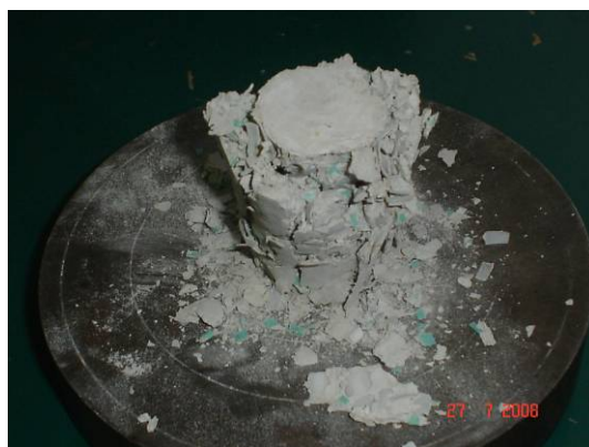
Figura 4: Fotografia após o ensaio mecânico de um corpo de prova constituído de areia e PET.
