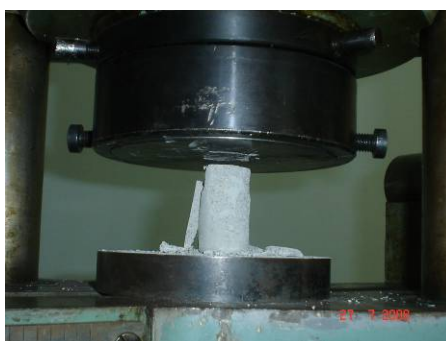
Figura 2: Fotografia durante ensaio mecânico de um corpo de prova constituído de areia e cimento.
