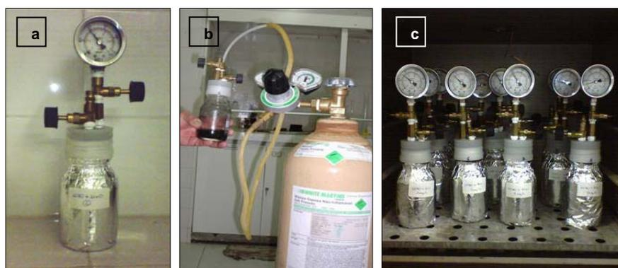
Figura 2. Etapas seguintes do Ensaio BMP: (a) Recirculação da mistura N<sub>2</sub>/CO<sub>2</sub> nos frascos; (b) Fechamento do frasco e colocação do manômetro; (c) Frascos incubados na estufa (37°C).
