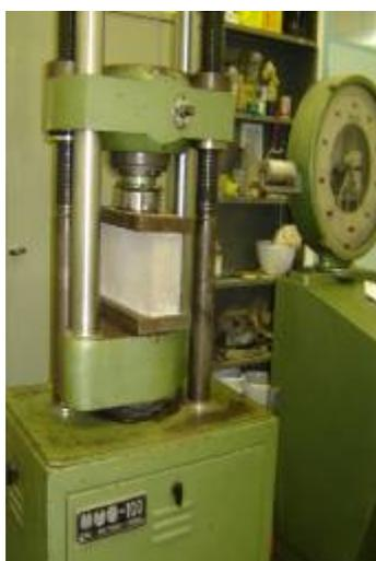
Figura 02. Ensaio de resistência à compressão simples
