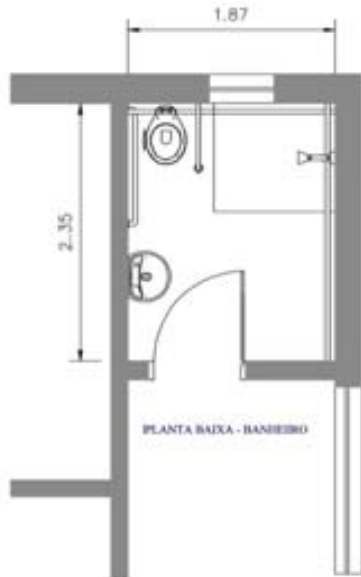
Figura 3: planta de banheiro adaptada. Fonte: VIZIOLI, 2003
