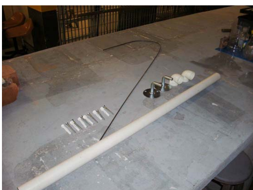
Figura 11: materiais utilizados para execução da barra de apoio alternativa.
