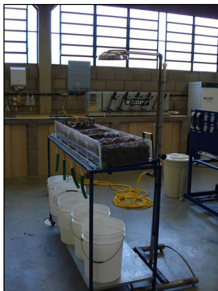
Figura 2: Vista da montagem do experimento, sendo alterada em cada etapa, apenas a disposição das amostras de solo, plana/0°, inclinada 15° e 30°.
