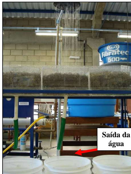
Figura 6 Detalhe da drenagem do experimento.
