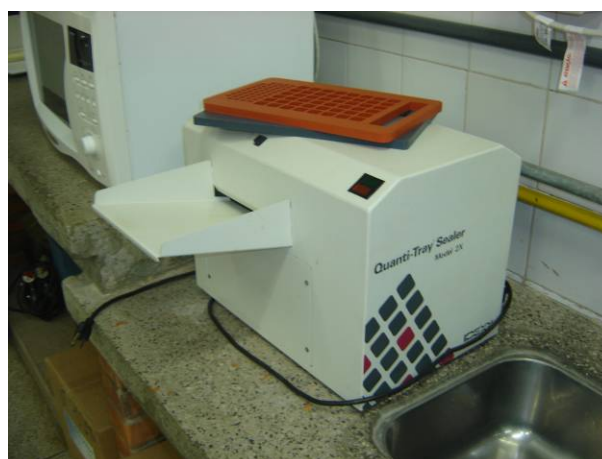
Figura 9: Seladora utilizada para selar as cartelas da Figura 8.
