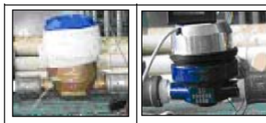
Figura 8 – Hidrômetros da FABRICANTE 2 (direita: 10 mL/pulso) e FABRICANTE 3 (esquerda: 6 mL/pulso)
