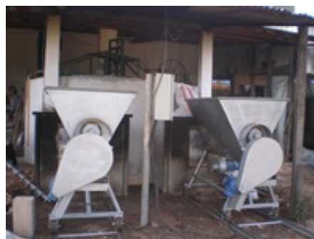
Figura 2: Fornos de queima da massa fibrosa e da casca.
