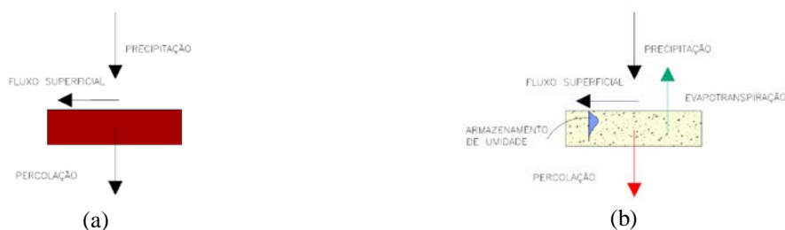
Figura 1 - Balanço Hídrico em uma cobertura convencional (a) e cobertura evapotranspirativa (b) (McCartney & Zornberg, 2004)
