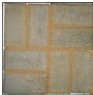
Figura 2 – Protótipo de Bloco de Concreto
