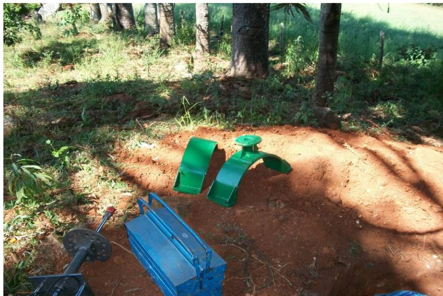
**Figura 07: Imagem da abraçadeira especial bi-partida utilizada para a implantação das ventosas na AAB Rio Pato Branco.**
