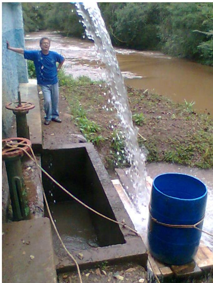
**Figura 04: Medição de vazão, utilizando bombona, do extravasor da câmara de sucção do Alto Recalque da Captação Rio Pato Branco.**
