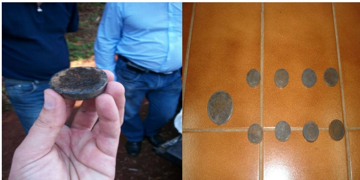
**Figura 09: Imagem das paredes das tubulações perfuradas para implantação de ventosa em rede em carga.**
