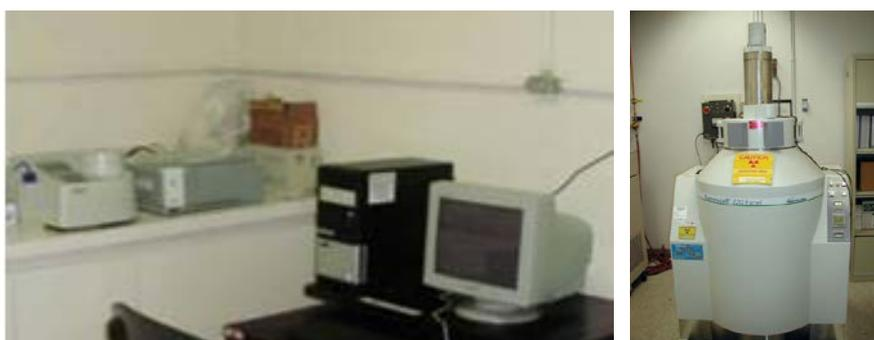
Figura 1 : Foto do Espectrofotômetro UV-Vis (a) e do Gamma Cell (b)
