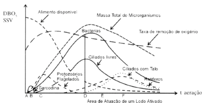
Figura 1: Diagrama de Predominância das diferentes espécies de microrganismos em função da carga orgânica do sistema de tratamento de lodo ativado.
