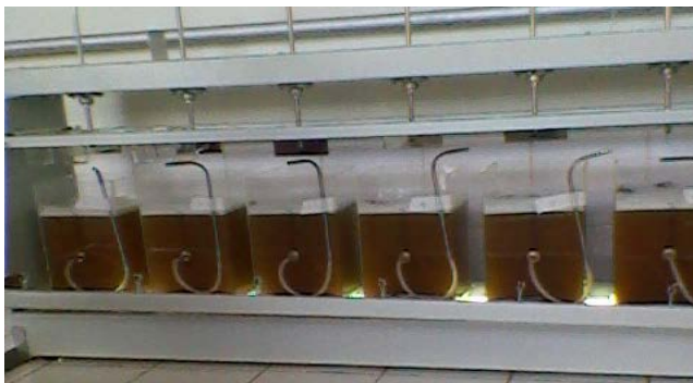
Figura 1: Equipamento de Jar Test de bancada com efluente.
