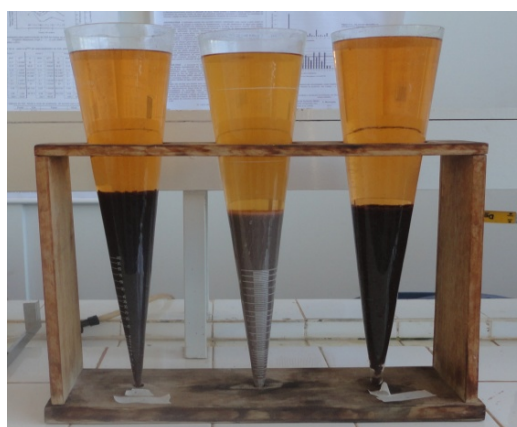
Figura 3: Foto ilustrativa do processo de decantação em Cones Imhoff®, após 10 minutos de sedimentação.
