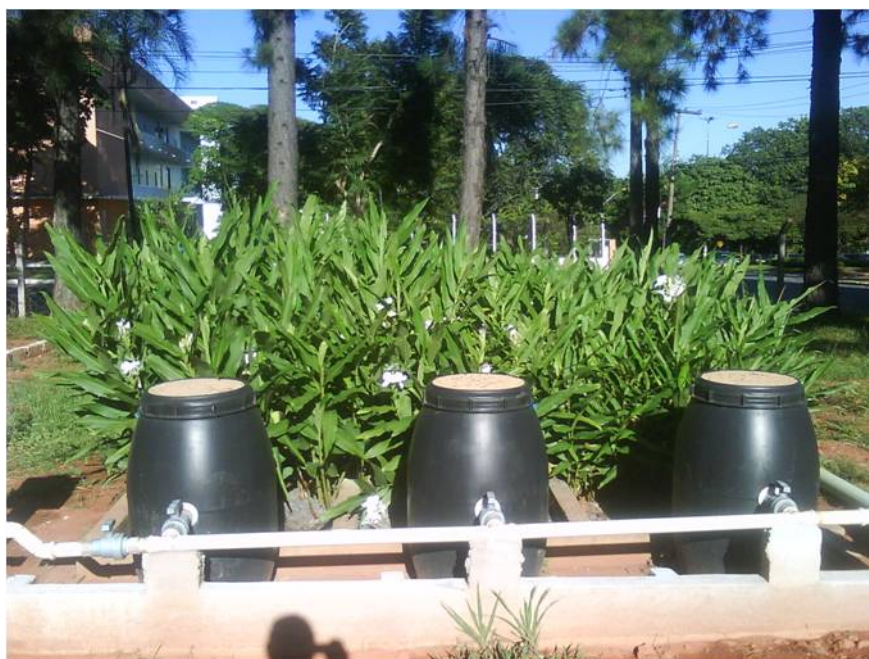
Figura 5: Vista das três unidades de zona de raízes da estação experimental de tratamento de esgoto da unidade universitária EE-UFG vegetadas com Lírio do Brejo ( Hedychium coronarium ).
