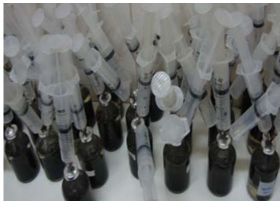
Figura 1 – Frascos penicilina de 100mL usados nos ensaios de digestão anaeróbia do lodo para avaliar o volume e composição do gás gerado e a redução de sólidos.
