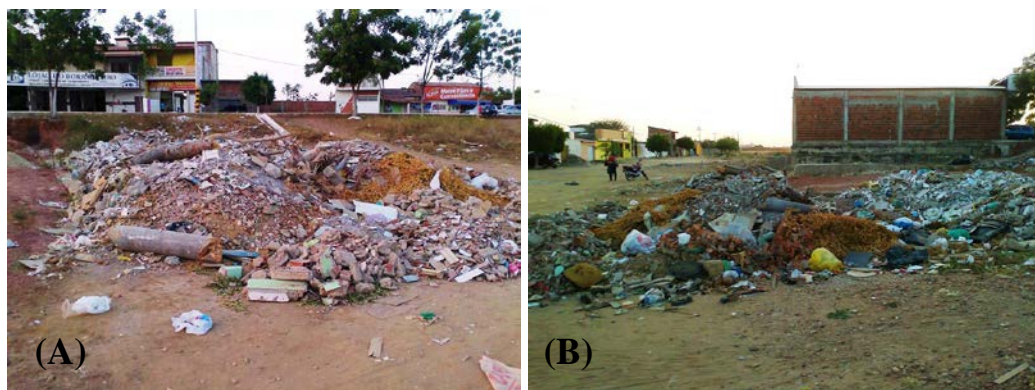
Figura 3: Vistas de deposições de resíduos da construção e demolição: (A) agregado miúdo (areia), madeira, detritos de alvenaria com tijolos com 8 furos e gesso; (B) agregado miúdo (areia), madeira, detritos de alvenaria, gesso e telha. Avenida Centenária, Bairro Aeroporto. Mossoró, RN, 07/10/11. Coordenadas geográficas: 5°11'34''S e 37°22'13''W.
