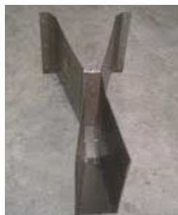
Figura 4: Vista general de la canaleta Parshall construida
