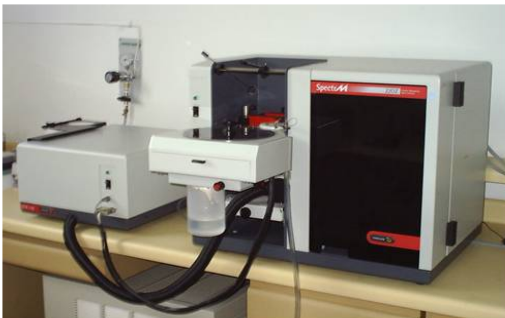
Figura 1 – Espectrômetro de absorção atômica com atomizador eletrotérmico em forno de grafite – GFASS, EAA, modelo 220Z
