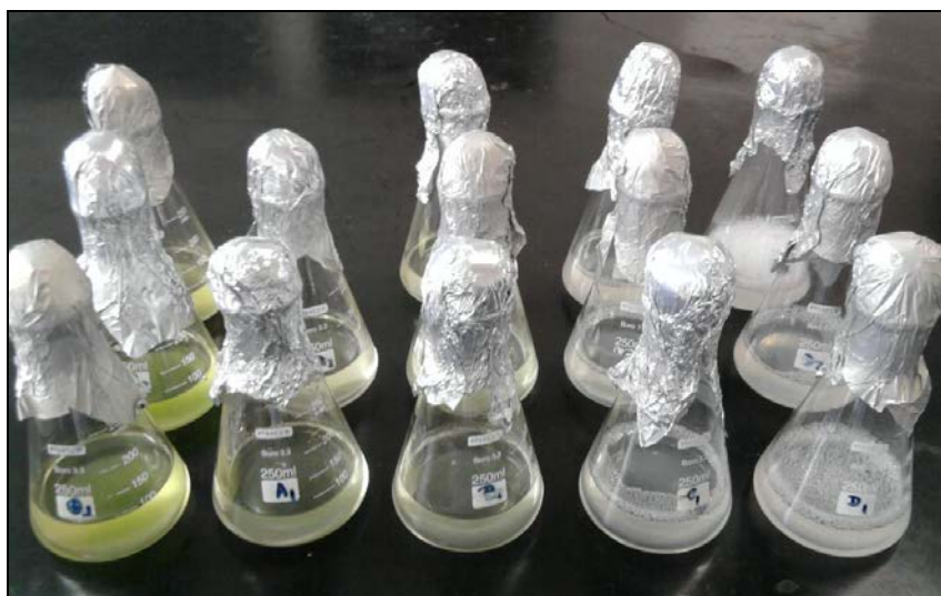
Figura 7: Soluções-teste e controles* ao final de 72 horas de exposição a uma mistura 8% v/v dos principais surfactantes empregados no processo produtivo de uma indústria de cosméticos (Controles: Frascos à esquerda com tonalidade verde).
