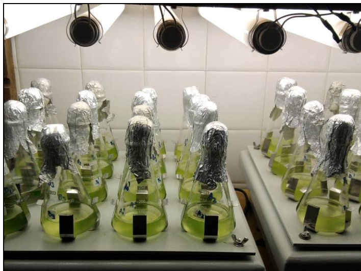
Figura 2: Soluções-teste ao final de 72 horas de exposição às amostras provenientes da eluição com metanol das colunas C18 empregadas no processo de extração em fase sólida.
