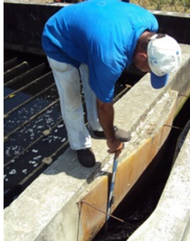
Figura 5: Medição de vazão na ETE Orlando Dantas (BARROS, 2009).
