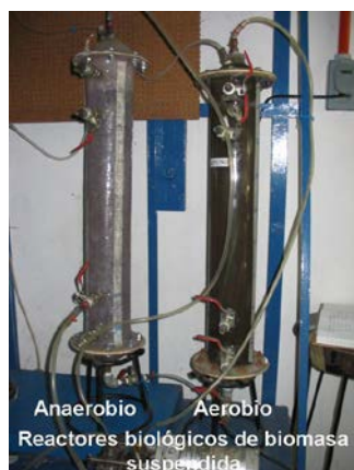
Figura 5. Reactores anaerobio - aerobio con biomasa en suspensión, alimentados con Azul directo 2.
