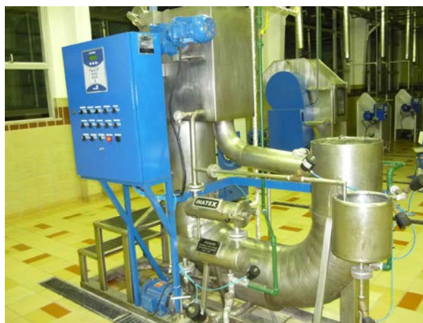
Figura 2: over-flow (Jet) em escala piloto.
