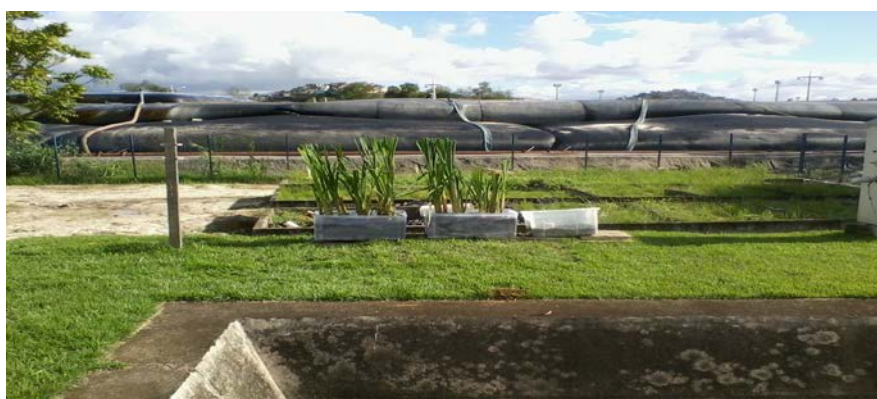
Figura 2: Vista Geral das caixas utilizadas para simular o sistema de wetlands
