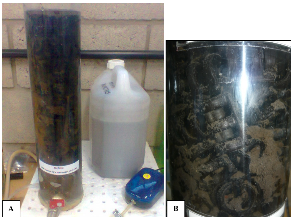
Figura 5 – A. Reator com considerável incidência de massa microbológica aderida e B. Detalhe para incidência da massa microbológica
