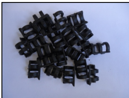
Figura 3 – Estrutura do tipo Anel de Pall utilizada no sistema.
