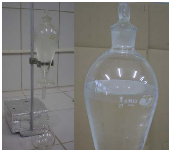
Figura 11: Funil de separação para extração de Óleos e Graxas
