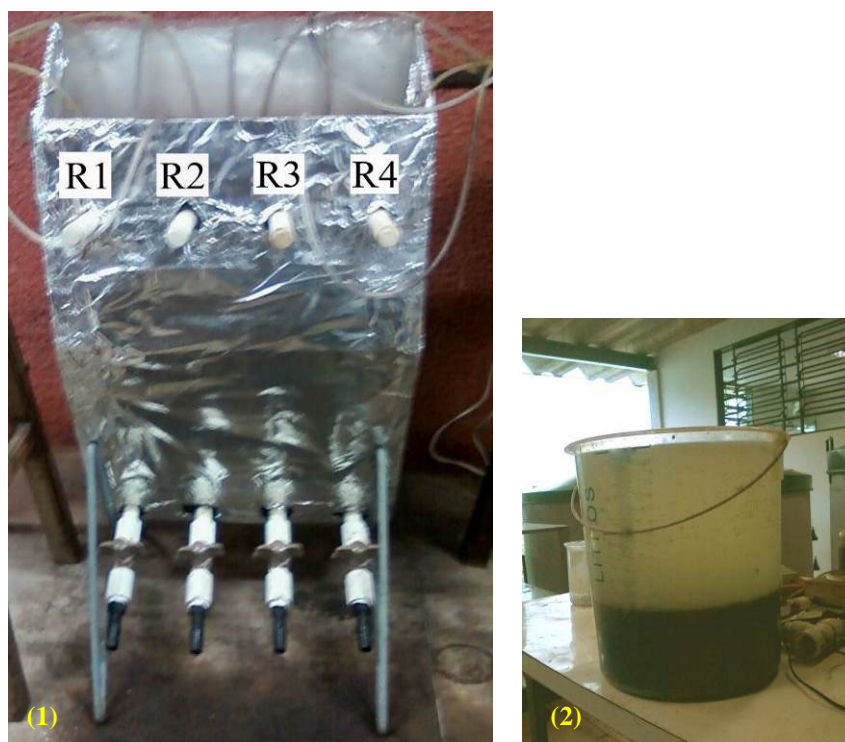
Figura 1 – (1) Célula de aeração com 4 reatores de 10 L cada e (2) unidades de sedimentação, utilizada nos experimentos em escala de bancada.
