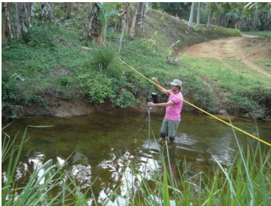
Figura 2: Medição de vazão a vau, com FlowTracker. (Fonte: Autor)
