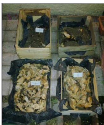
Figura 3. Construcción de las biopilas en cajones de madera forrados con plástico.
