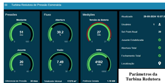
Figura 10 – Parâmetros da Turbina Redutora de Pressão (28/05/2024)
