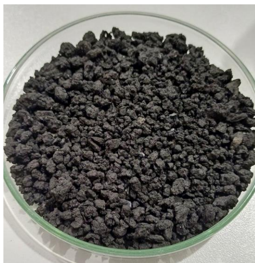
Figura 3: Biochar produzido a partir do lodo de esgoto, após tratamento com MgCl 2 .
