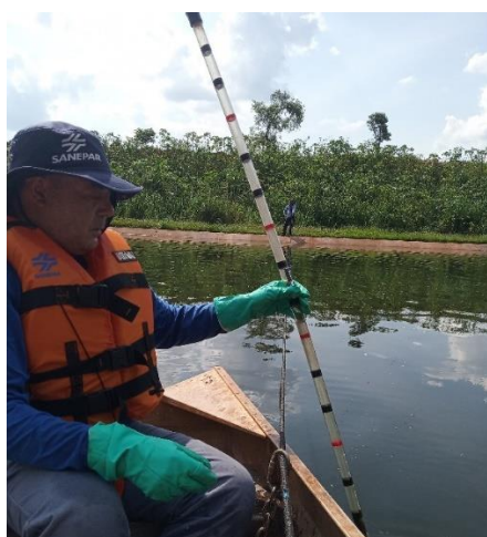
Figura 2: Levantamento batimétrico com coletor e medidor de perfil de sólidos.
