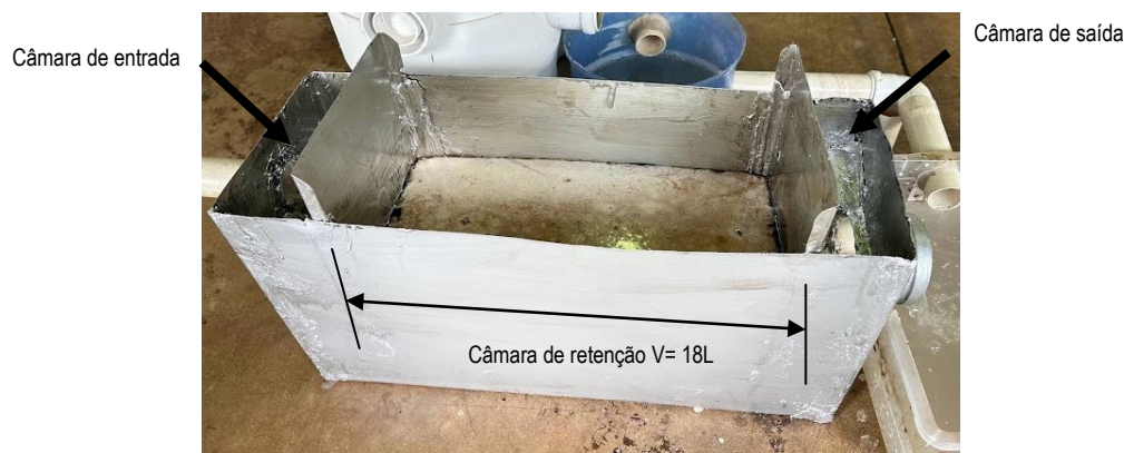
Figura 2: Caixa de gordura Protótipo.
