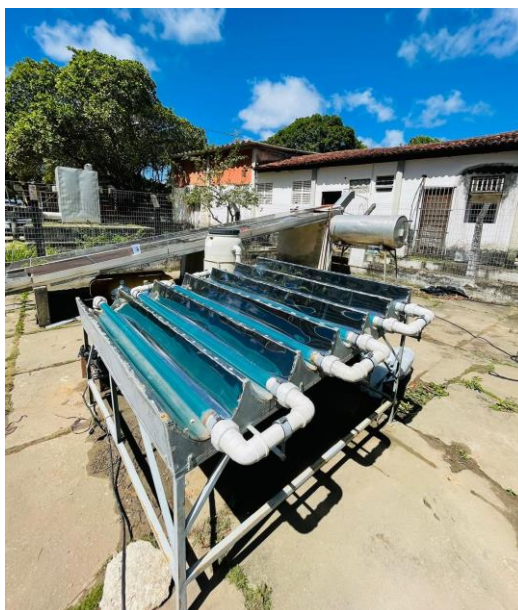
Figura 1: Experimento de fotodegradação de azul de metileno por meio de fotocatalise heterogênea em fotorreator solar com coletor parabólico composto.
