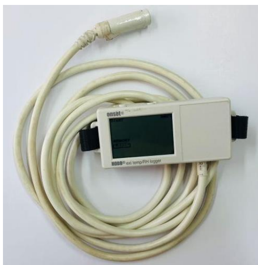
Figura 3 – Sensor de temperatura e umidade relativa, Onset HOB0 UX100-023. Fonte: Autoria própria (2022).
