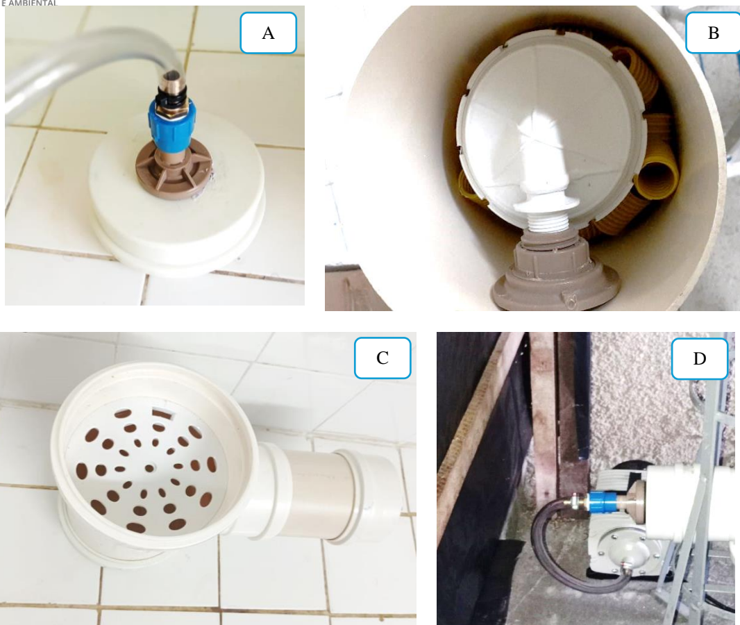
Figura 2: Construção da torre: A) Conexões para o recolhimento do gás amônia; B) Distribuidor do afluente; C) Fundo falso; D) Entrada do gás de arraste
