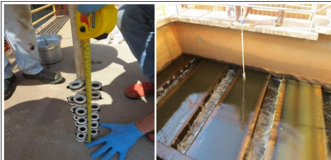
Figura 4: Equipamento para avaliar a expansão do meio filtrante. Fonte: Di Bernardo et al. (2017)
