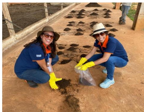
Figuras 12 e 13 – Etapa do quarteamento e coleta de amostras.
