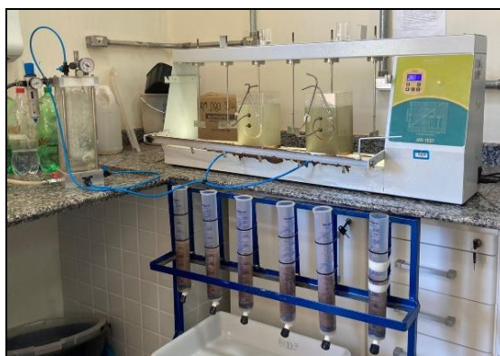
Figura 3: Estrutura dos filtros.
