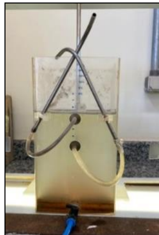
Figura 2: Jarro com as duas saídas para coleta, indicação de volume e taxa de recirculação
