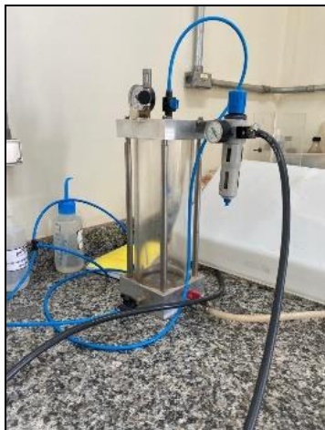
Figura 1: Câmara de pressurização.
