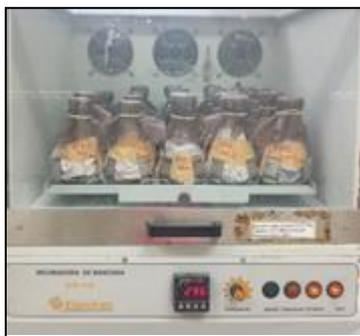
**Figura 1: reatores montados em mesa agitadora a 150 rotações por minuto (rpm).**
