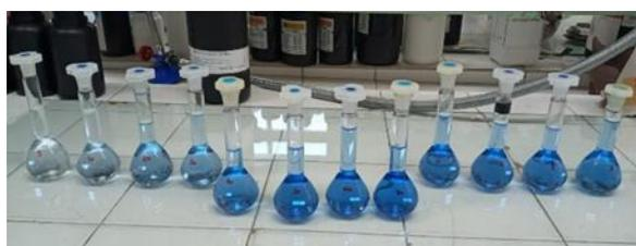
**Figura 2: Diluições para curva de determinação de paraquat.**
