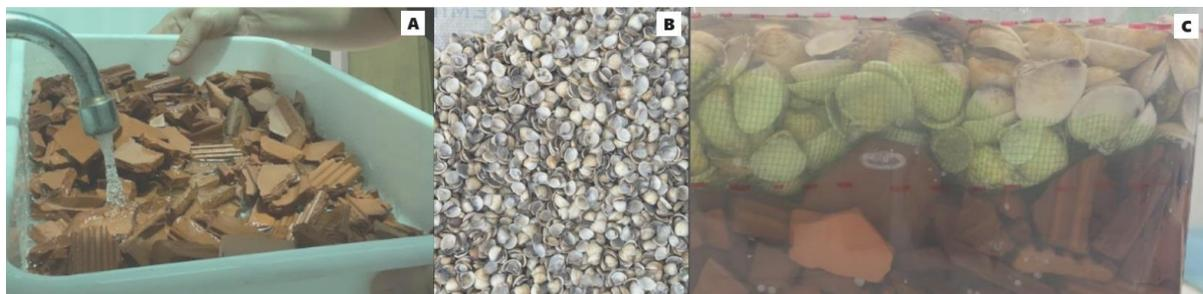
**Figura 1: Substratos que compuseram os wetlands construídos**
