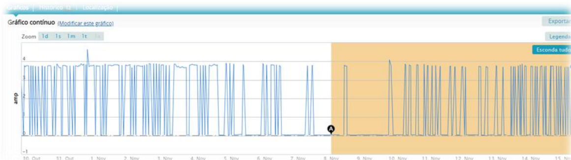
Figura 9 – Evento de nível de esgoto (obstrução identificada)
