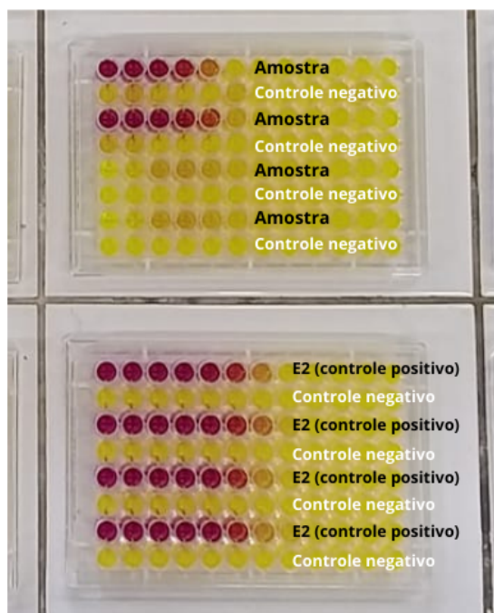
Figura 3: Exemplo de arranjo das placas do ensaio YES
