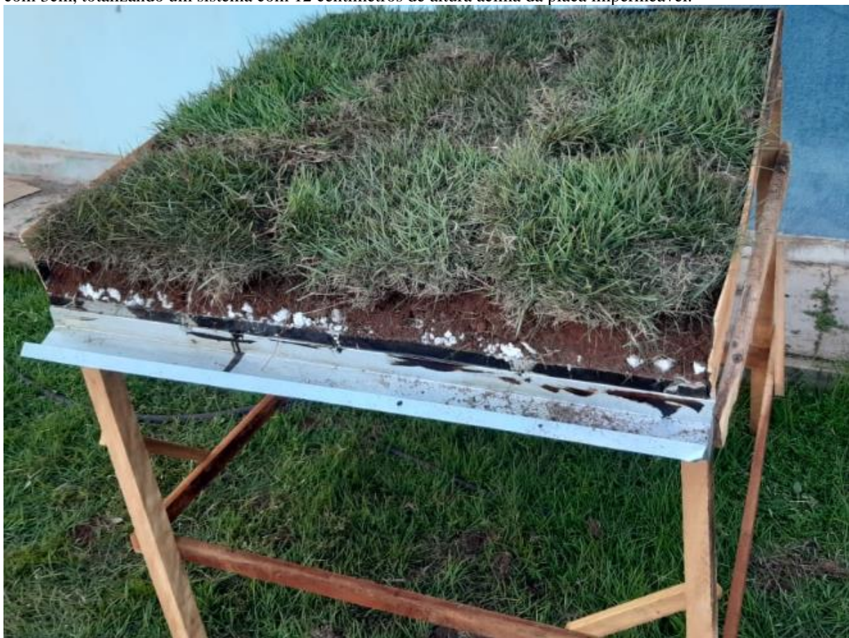
Figura 3: Protótipo telhado verde, segunda etapa.
