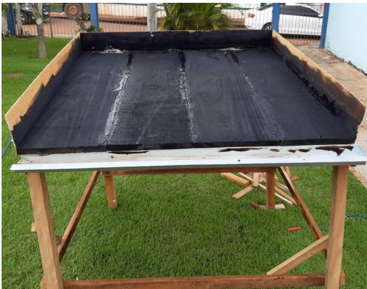
Figura 1: Protótipo de telhado convencional, primeira etapa de testes.
