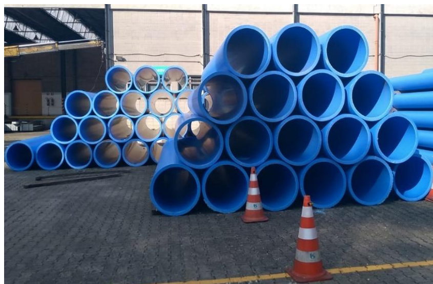
Figura 5 – Tubos em Pead 800 mm usados na obra
