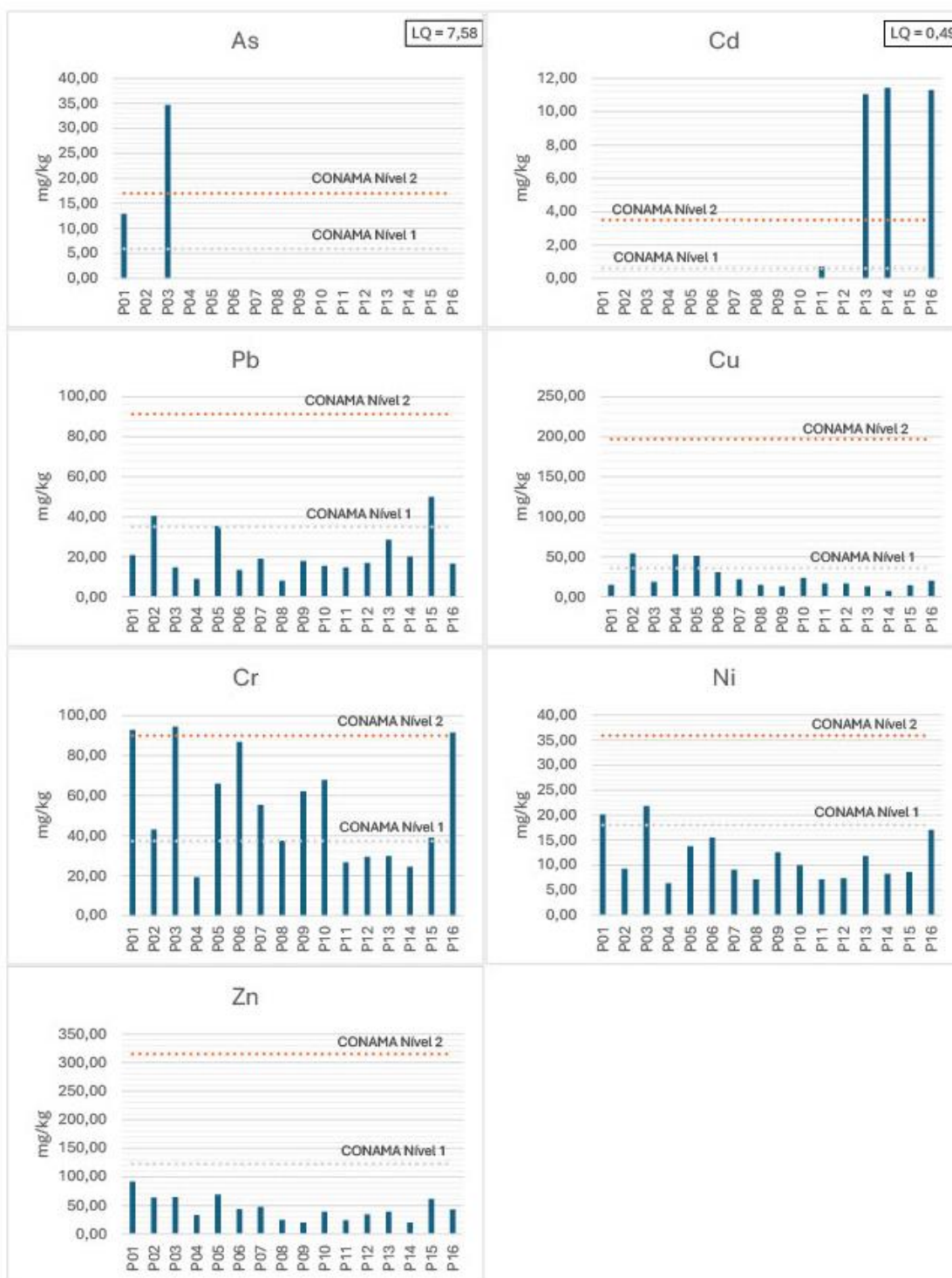
Figura 10 - Diagramas das concentrações de As, Cd, Pb, Cu, Cr, Ni e Zn ao longo da Bacia do Rio Santo Antônio e comparativo com CONAMA 454/2012.
