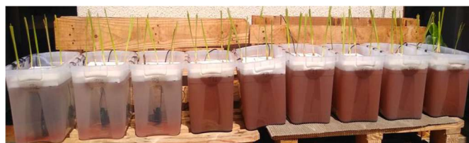
Figura 1: Experimento (ilhas flutuantes em escala reduzida), com mudas de Vetiver suspensas em placa de isopor
